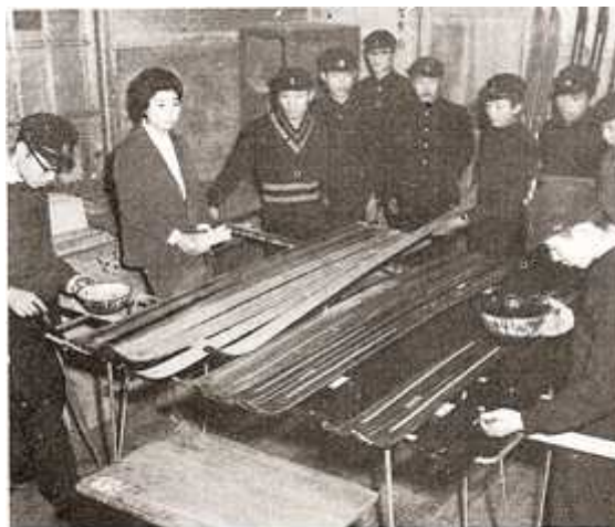
合板スキーにセルロイドを貼り塗装仕上げ
